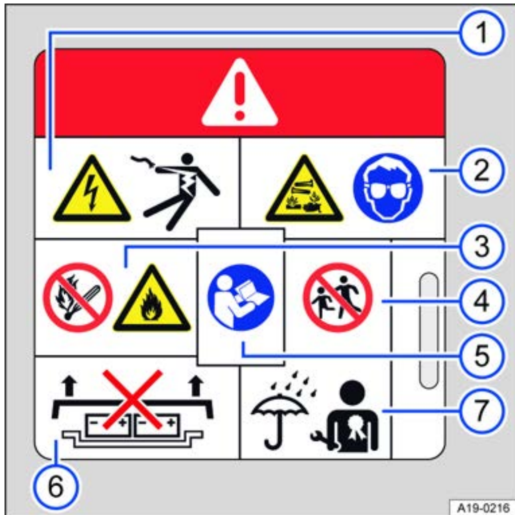
Abb. 4 Warnschild auf der Hochvoltbatterie.
