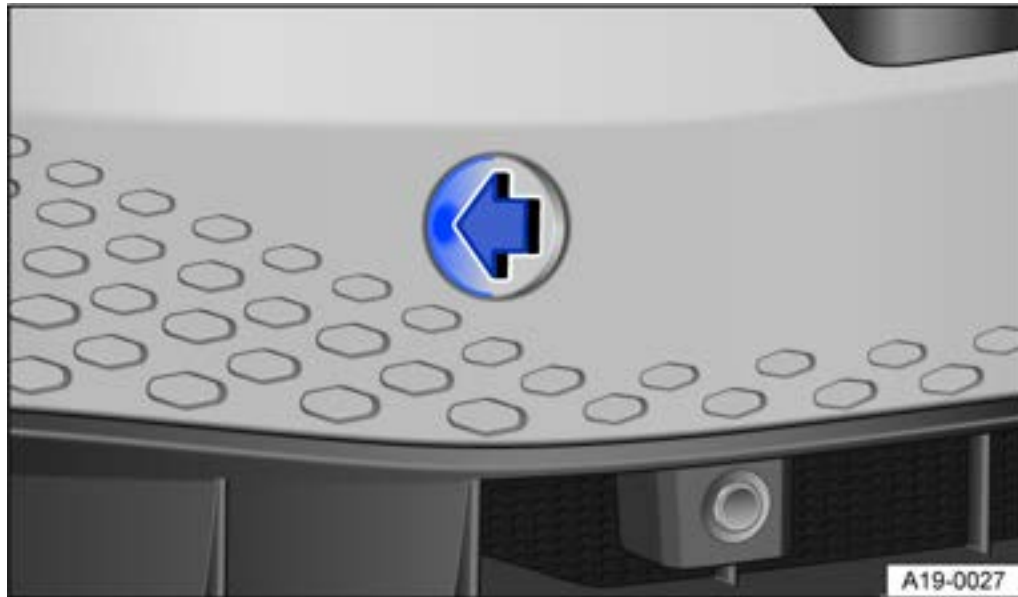
Abb. 1 Im Stoßfänger vorn rechts: Abdeckung abnehmen.
