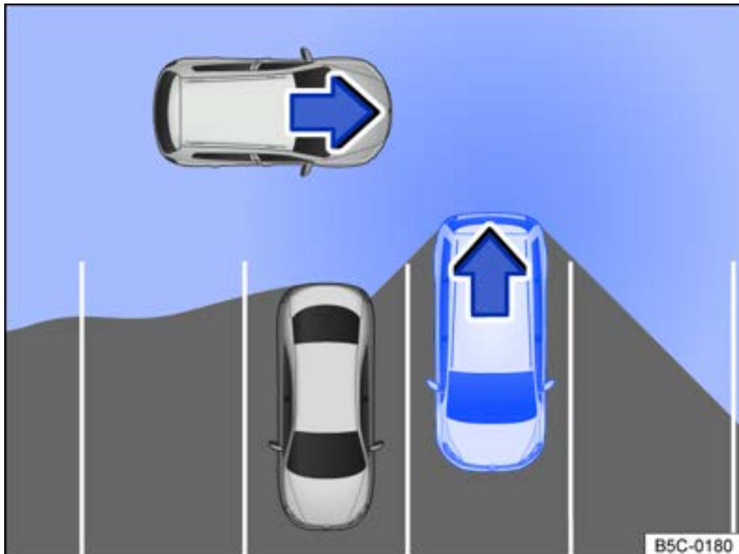
Abb. 1 Prinzipdarstellung Ausparkassistent: Überwacher Bereich um das ausparkende Fahrzeug.
