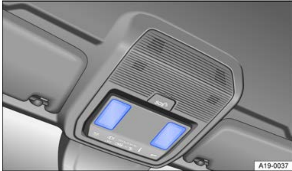
Abb. 1 In der Dachkonsole: Berührungssensitive Leseleuchten.
