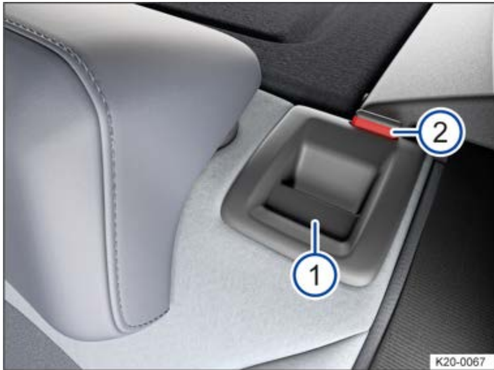
Abb. 1 In der Rücksitzlehne: Entriegelungstaste.
