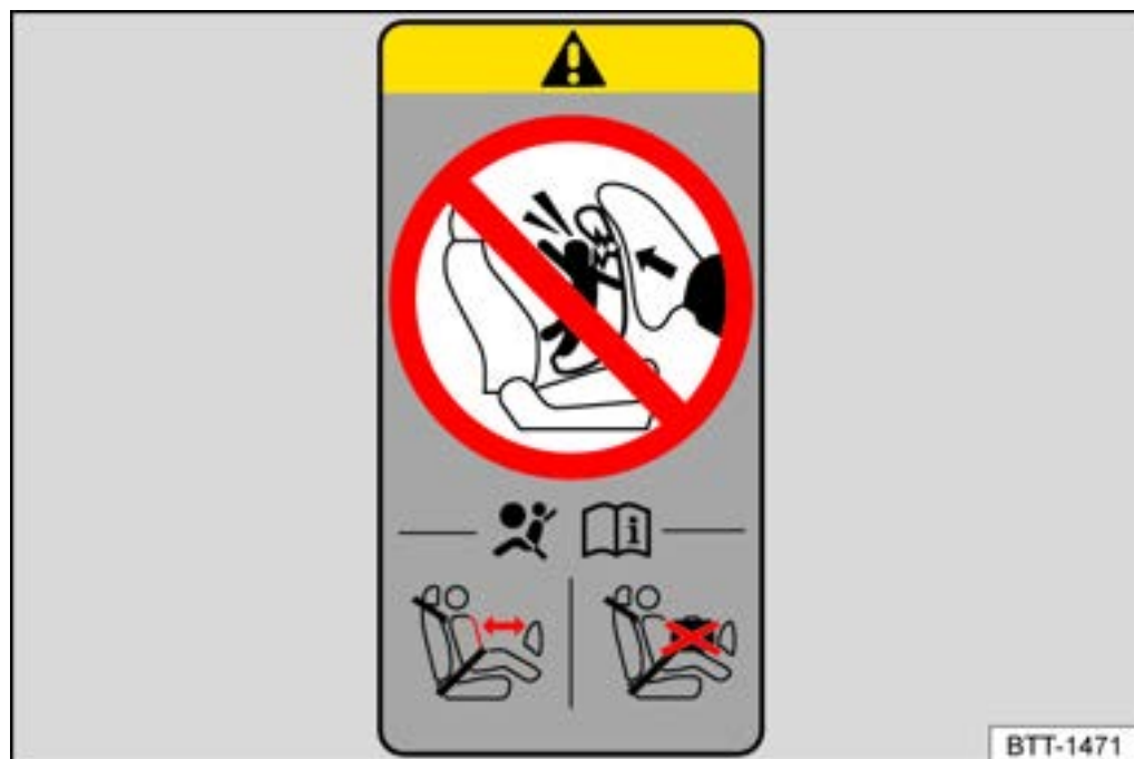
Abb. 2 Prinzipdarstellung: Airbag-Label an der B-Säule.
