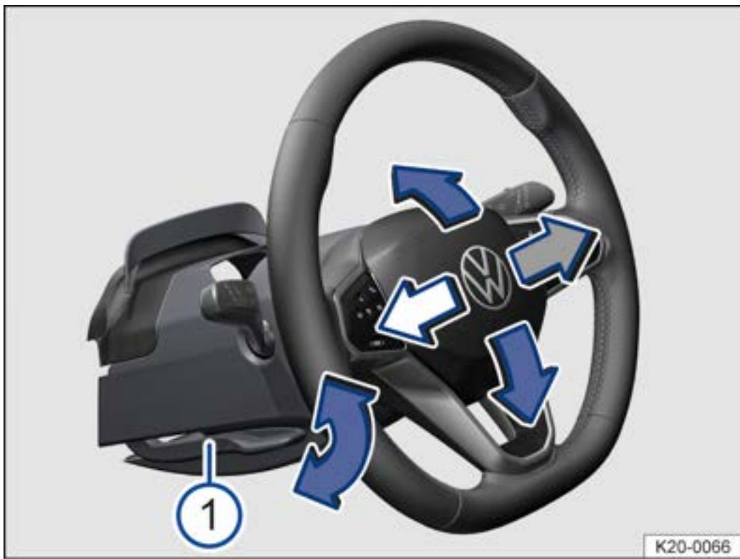
Abb. 1 Unter dem Lenkrad in der Lenksäulenverkleidung: Hebel für die mechanische Einstellung der Lenkradposition.
