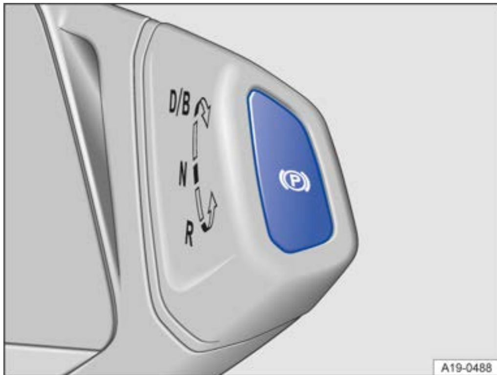
Abb. 1 Am Fahrstufenschalter: Taste für die elektronische Parkbremse.
