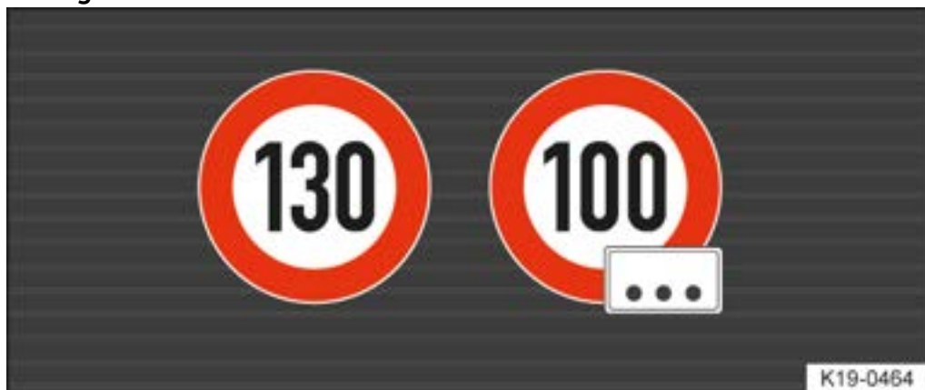
Abb. 1 Im Display des Kombi-Instruments: Beispiel für erkannte Geschwindigkeitsgebote mit generischem Zusatzzeichen.
