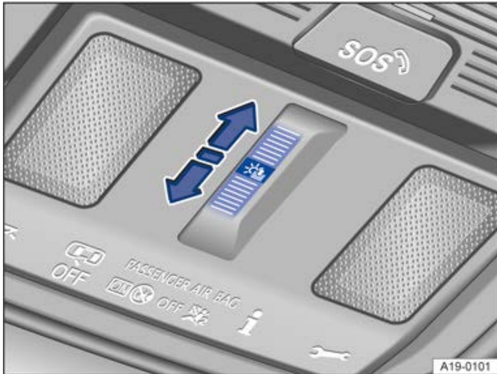
Abb. 1 Im Dachhimmel: Funktionsfläche zur Steuerung des Sonnenschutzrollos.
