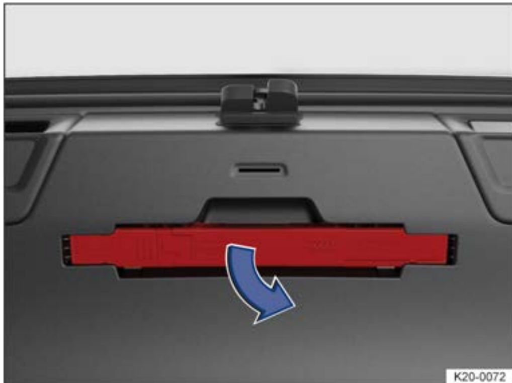
Abb. 1 In der Heckklappe: Halterung für das Warndreieck.
