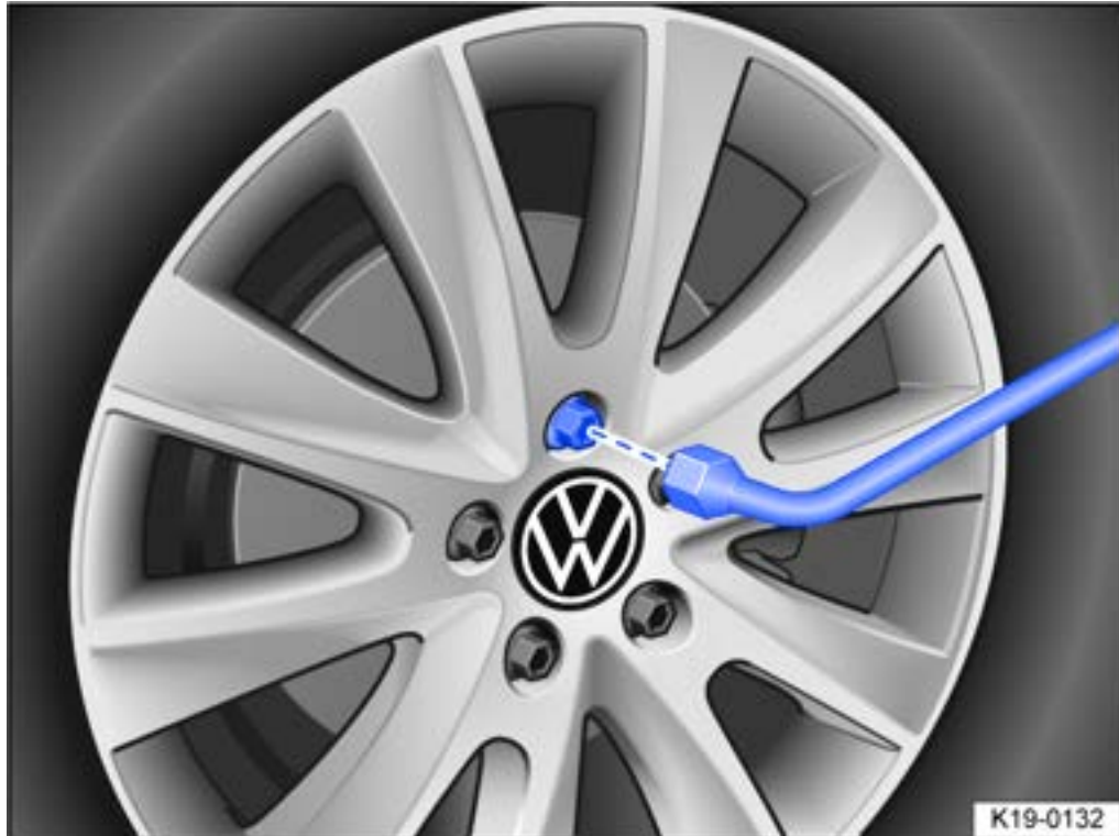
Abb. 1 Radwechsel: Radschrauben mit dem Radschlüssel abschrauben.
