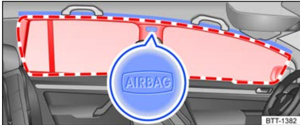
Abb. 1 Auf der linken Fahrzeugseite: Einbauort und Entfaltungsbereich des Kopfairbags.
