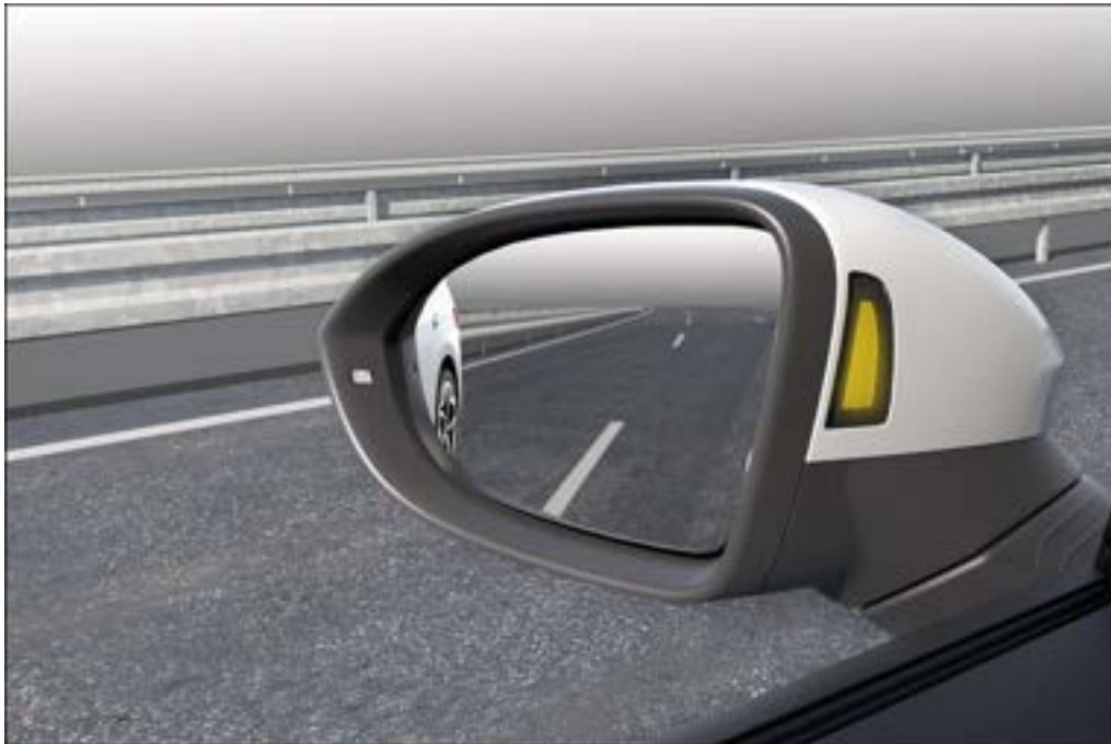
Abb. 1 Im Gehäuse der Außenspiegel: Optische Anzeigen des Spurwechselassistenten.
