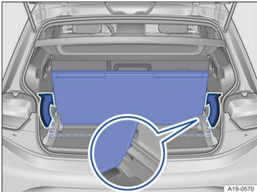
Abb. 2 Im Gepäckraum: Zweiten Gepäckraumboden arretieren.
