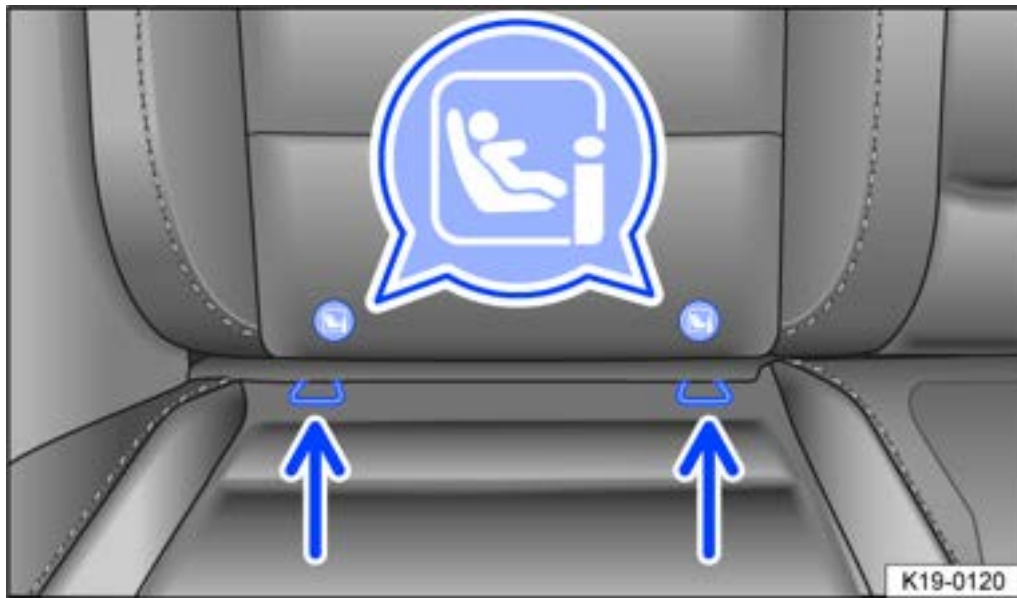
Abb. 3 Kennzeichnung der i-Size-Verankerungspunkte für Kindersitze am Beifahrersitz.
