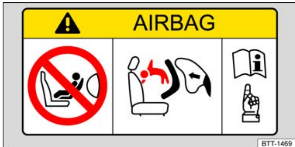
Abb. 1 Prinzipdarstellung: Airbag-Label an der Sonnenblende.
