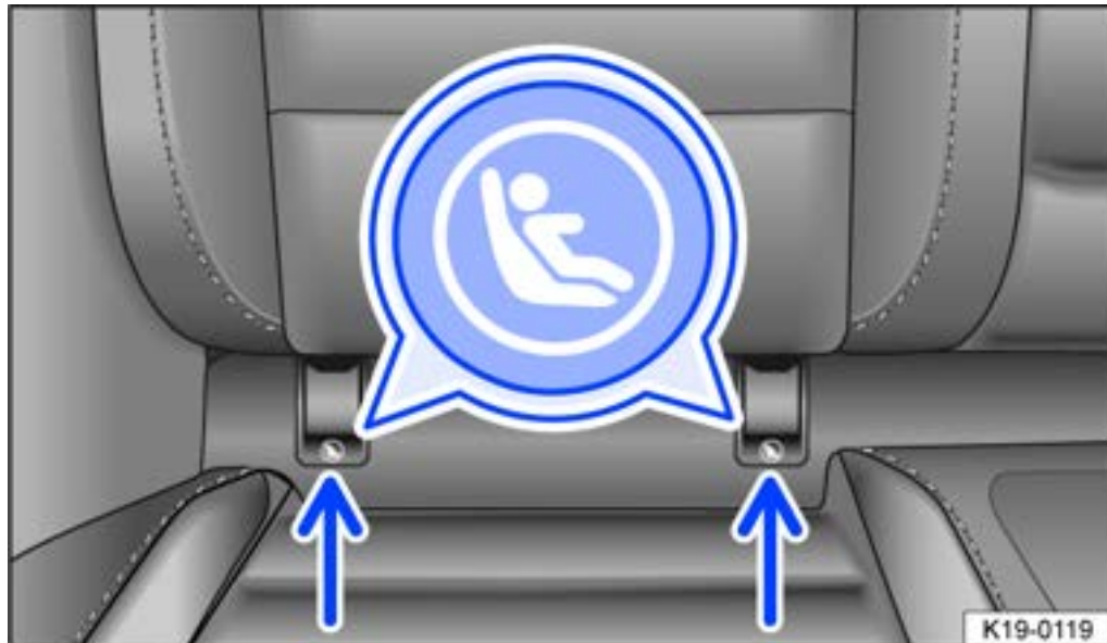
Abb. 1 Kennzeichnung der ISOFIX-Verankerungspunkte für Kindersitze an den Sitzplätzen der Rücksitzbank.
