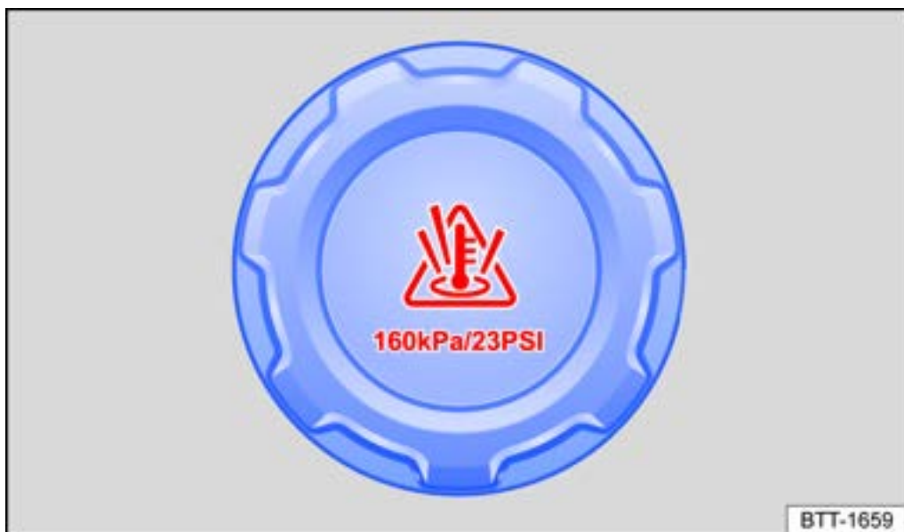
Abb. 2 Unter der Frontklappe: Deckel des Motorkühlmittelausgleichsbehälters (Prinzipdarstellung).
