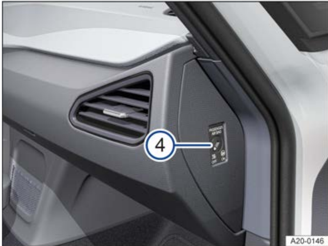
Abb. 2 Bei geöffneter Beifahrertür (Linkslenker): Schlüsselschalter in der Instrumententafel (Rechtslenker ist spiegelbildlich).
