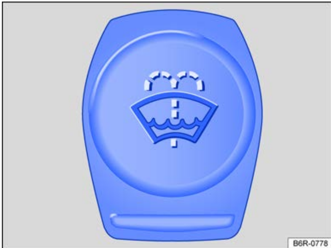
Abb. 1 Im Frontraum: Deckel des Scheibenwaschwasserbehälters.
