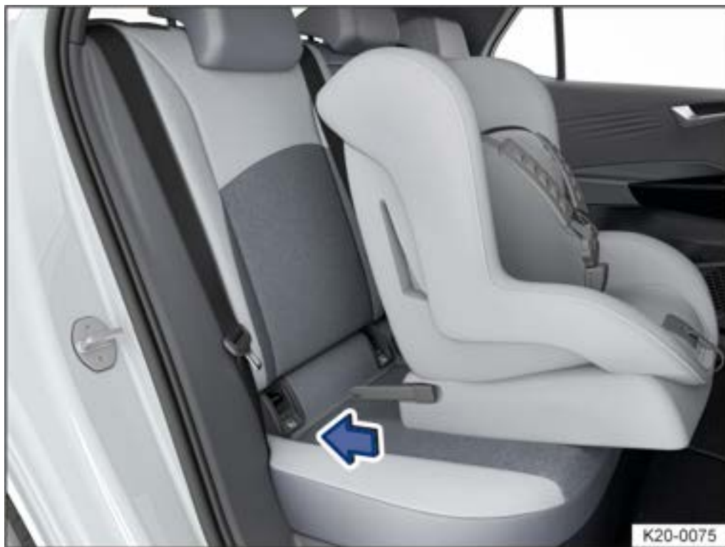
Abb. 4 Prinzipdarstellung: Kindersitz mit Rastarmen einbauen.
