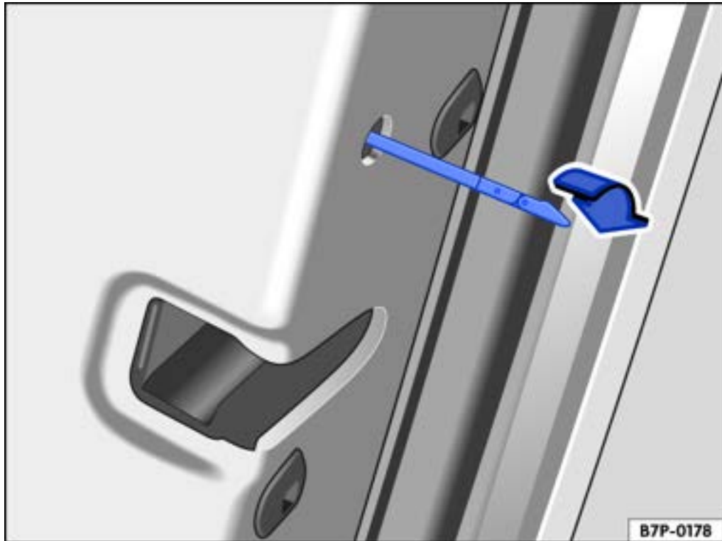
Abb. 1 In der Stirnseite der hinteren rechten Tür: Notverriegelung des Fahrzeugs mit dem Notschlüssel.
