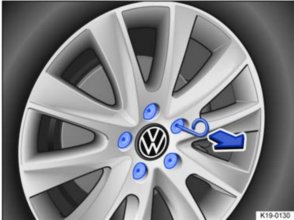
Abb. 1 Abdeckkappen von den Radschrauben abziehen.
