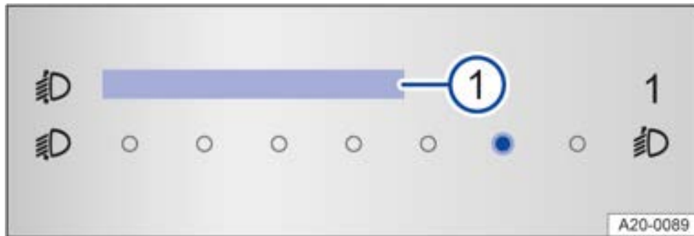
Abb. 1 Im Infotainment-System: Touch-Regler für Leuchtweitenregulierung.
