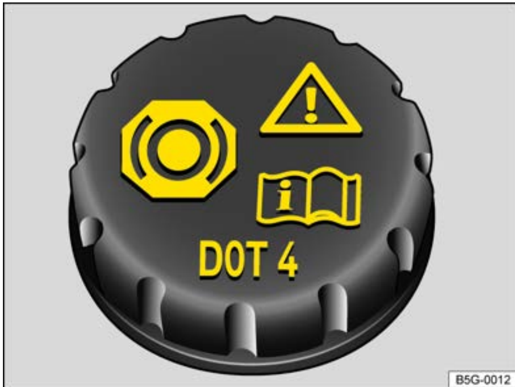
Abb. 1 Im Frontraum: Deckel des Bremsflüssigkeitsbehälters.
