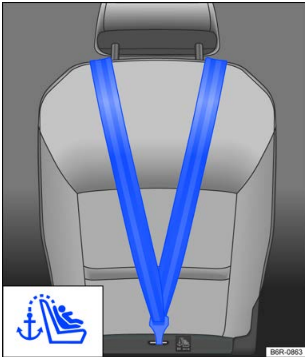
Abb. 2 An der Rückseite des Beifahrersitzes: Eingehängter oberer Haltegurt.
