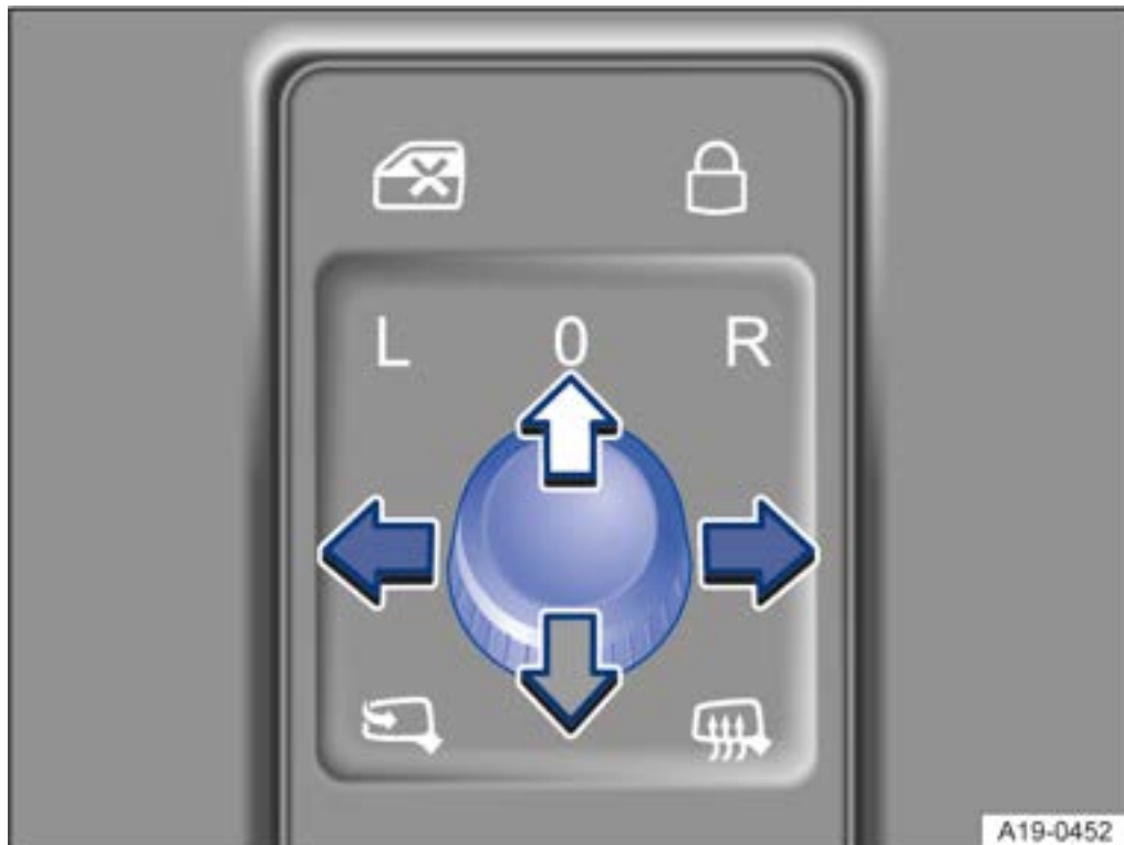
Abb. 1 In der Fahrertür: Drehknopf für die Außenspiegel.
