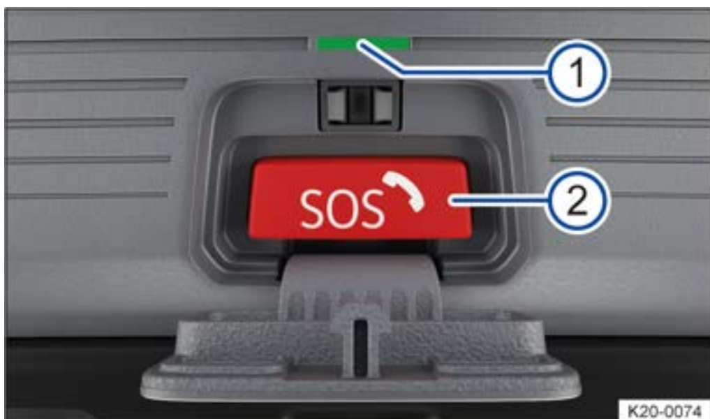
Abb. 2 Bedienelement für Notruf: Kontrollleuchte und Taste.
