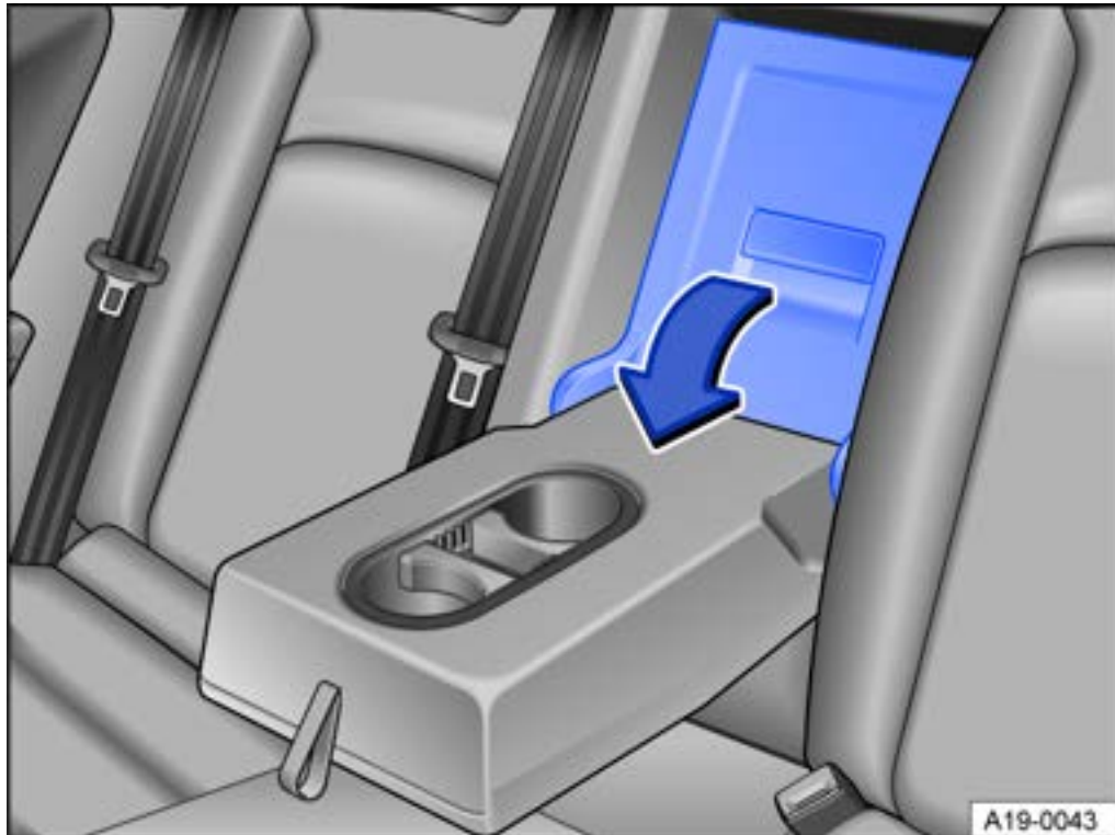
Abb. 1 In der Rücksitzlehne: Durchladeeinrichtung öffnen.
