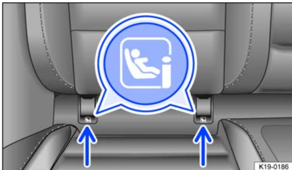
Abb. 2 Kennzeichnung der i-Size-Verankerungspunkte für Kindersitze an den Sitzplätzen der Rücksitzbank.
